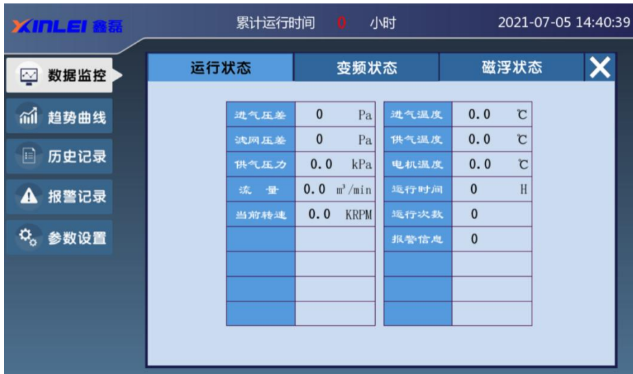
图5-3 可查看设备、变频器、磁浮控制器的运行数据
